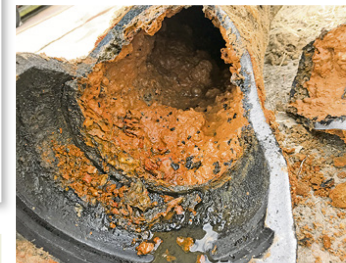
Zeit für einen Wechsel: Bei derart abgenutzten Leitungen helfen auch keine Rohrspülungen mehr.
